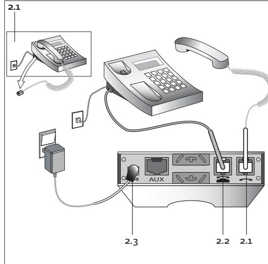
[2.1] Das Handapparat-Spiralkabel aus der Buchse am Telefon ziehen und unten in die Basisstation stecken.
